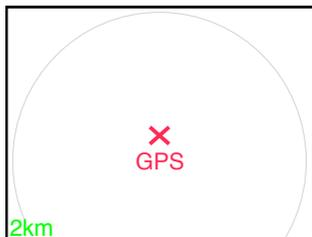
Abbildung 7.2.: ATD hat keine Positionsdaten. "NO GPS" Hinweis wird statt des eigenen Luftfahrzeugsymbols angezeigt. Der Ring-Indikator für ungerichteten Verkehr wird angezeigt.
