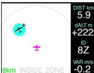
Abbildung 4.7.: Das eigene LFZ befindet sich innerhalb einer großen Warnzone. Aufgrund der gewählten Vergrößerung sind die Zonengrenze und der Referenzpunkt nicht sichtbar.
