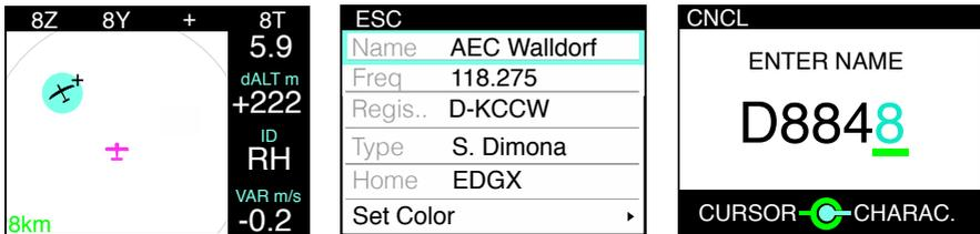
Abbildung 1.5.: Radaransicht, Menü, Texteingabe-Seite. Der innere Drehknopf steuert immer cyan-farbige Elemente, der äussere Drehknopf immer grün-farbige Elemente.
